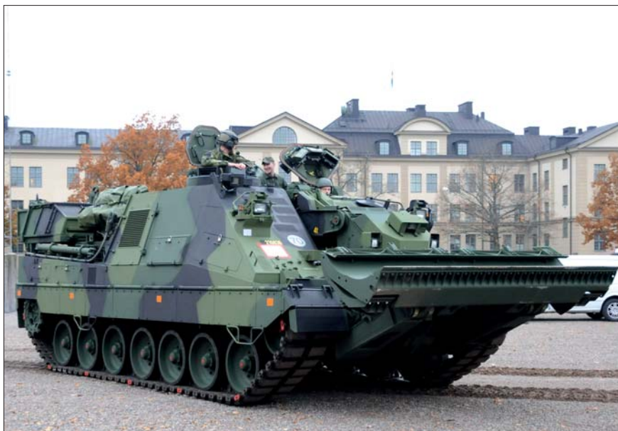
Ingenjörbandvagn 120 i Eksjö med utrustning i transportläge på bakpansaret.
