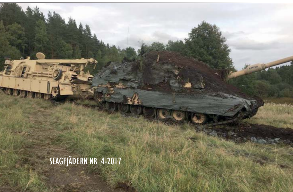
En amerikansk M 88 bärgningsbandvagn med en vikt på 70 ton drog upp stridsvagnen med 140 tons dragkraft. Efter 24 timmars besök på verkstad var stridsvagnen åter i elden igen.
