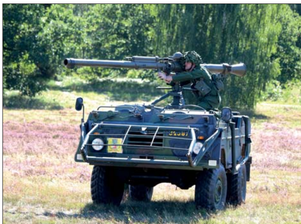
Skytte med PV-pjäs 1110, med inskjutningsvapen AG m/42B i 7,62x51 mm på ovansidan.
