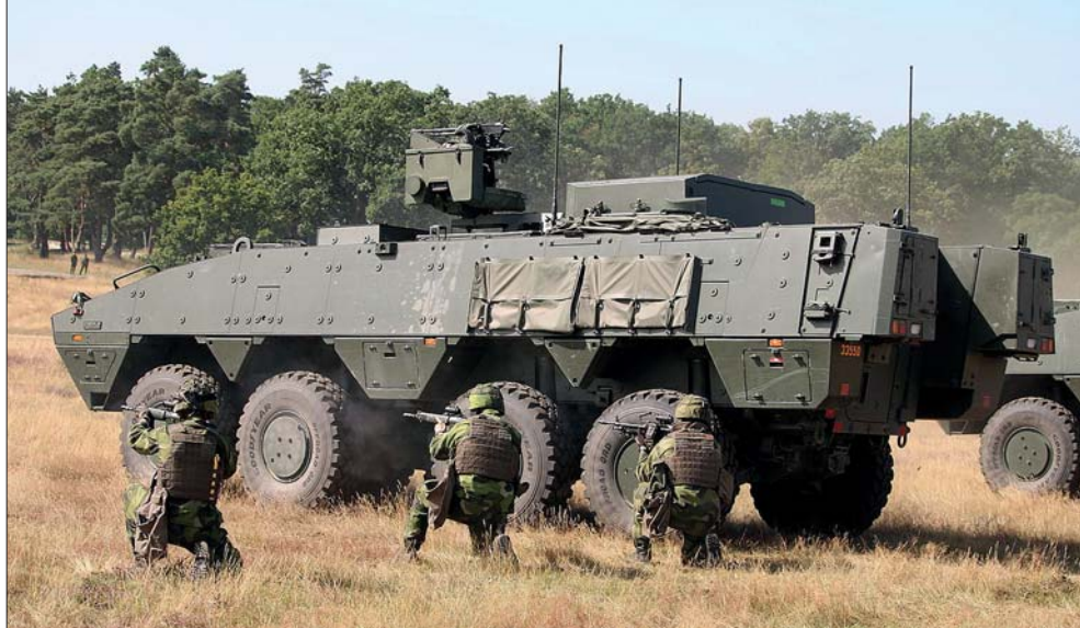
Pansarterrängbil 360 finns för närvarande på P 7 och Livgardet. Sammanlagt köptes 113 enheter i fyra olika versioner. Den nyuppsatta 12. motoriserade skyttebataljonen har tagit över fordon från P 7. Stridsvikten är 27,5 ton och vagnen är beväpnad med en tung kulspruta med kaliber 12,7 mm i en särskild vapenstation.
