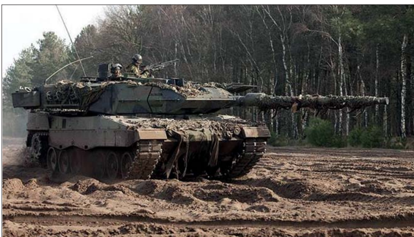
Finland har utöver sina 124 Leopard 2 A4 köpt 100 Leopard 2 A6 med det långa eldröret L/55. Detta ger stridsvagnen i kombination med den nya DM 63 ammunitionen en kraftigt ökad förmåga att slå igenom pansar.
