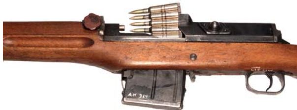
Påfyllning av blinda patroner i 6,5x55 mm på laddram, AG m/42B (AM.067225)
