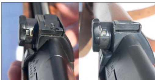
Sikte med val mellan rundnoskula (till vänster) och torpedkula (till höger) på AG m/42B.
