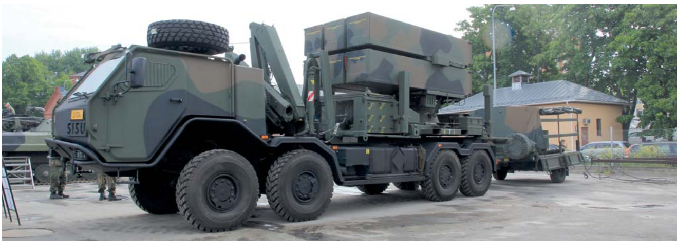
NASAMS 2 designades av Kongsberg i Norge för att skapa ett luftvärnsrobotsystem med ett befintligt jaktrobotsystem för stridsflyg. Tanken var att kunna använda robotarna antingen i luftvärnsrollen eller vid behov på stridsflygplanen. De finska systemen har ett specialkonstruerat terränggående splitterskyddat fordon av typ Sisu som ger ökad rörlighet till de sex luftvärnsrobotarna av typ AIM-120 AMRAAM. Räckvidden är 40 km vilket motsvarar våra robotsystem 97 HAWK. I övrigt har roboten ett eget målsökarsystem med radar.
