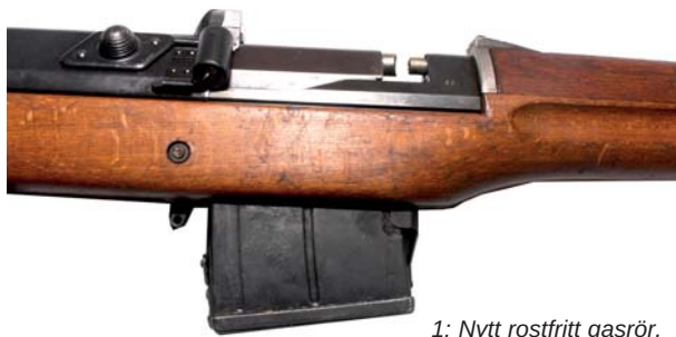
1: Nytt rostfritt gasrör.
