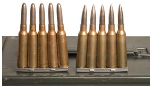
Patroner på ram till AG m/42B (och Mauser m/96): m/94 med m/94 rundnoskula till vänster och m/94 med m/41 torpedkula till höger.
