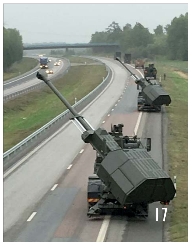
Det svenska artilleriets senaste tillskott Archer snabbgrupperad längs E 18. Vagnen är byggd på ett Volvo dumperchassi och har en totalvikt på 34 ton. Eldröret är lika långt som på de nya finska K 9 pansarhaubitsarna (L/52).
