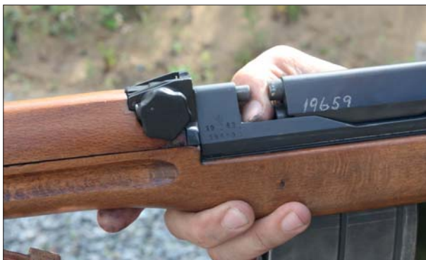
Vid patron ur måste man vara försiktig så att man inte gör detta med osäkrad mekanism när tummen trycker ned patronföraren. Då får man en "AG-tumme" när mekanismen slår igen.
